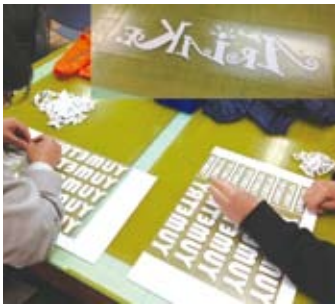
カス取り作業の様子
